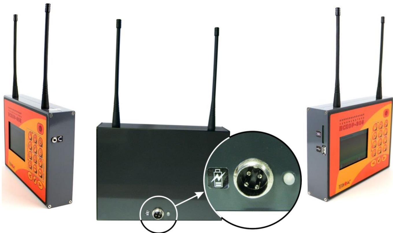
Рисунок 5 - Внешний вид корреляционного приемника «КП-305»
