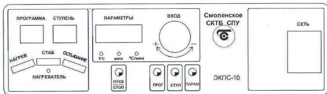
Рисунок 4 – Лицевая панель электропечи с многофункциональным блоком управления.
