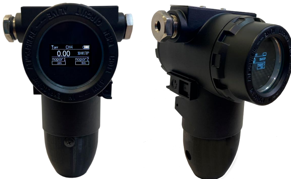
Рисунок 2.1 – Внешний вид ИКГС-ВР42 в алюминиевом корпусе
