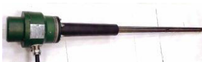
Рисунок 2 – Общий вид датчика кислорода с пробоотборным зондом
